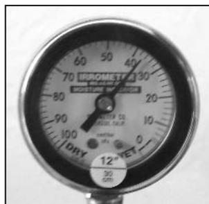
suelo, mediante gráficas de calibración de suelos. No hay lugar a dudas que el tensiómetro Irrometer® indica una unidad de medida de la humedad del suelo enteramente diferente.
