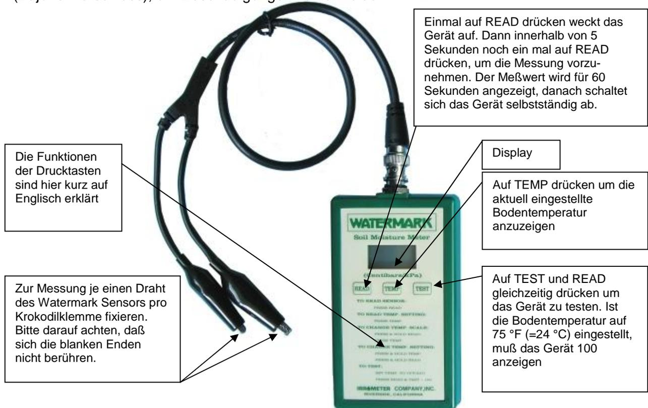
Außerdem kompensiert das Handauslesegerät durch eine eingebaute Funktion Temperaturschwankungen des Bodens automatisch, denn der Meßwert von Watermark Sensoren wird durch die Temperatur beeinflusst. Damit diese Funktion korrekt arbeitet, sollte die Bodentemperatur am Gerät auf den aktuellen Wert eingestellt sein.
