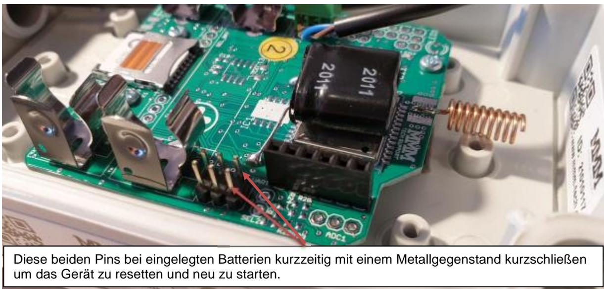
Diese beiden Pins bei eingelegten Batterien kurzzeitig mit einem Metallgegenstand kurzschließen um das Gerät zu resetten und neu zu starten.
