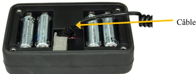
Figure 1. Câble de capteur branché dans la prise
