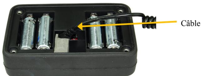
Fig. 1 : Câble de capteur raccordé.
