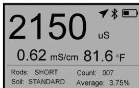
Les données de la TVE peuvent être obtenues avec un appareil comme une sonde à neutrons, en mesurant le poids d'une colonne de sol saturé de volume connu (car elle sèche progressivement), ou en mouillant graduellement un sol de volume connu avec l'ajout de paliers connus d'eau. Dans la plupart des cas, le calibrage est cependant effectué avec un échantillonnage gravimétrique. Cette procédure est brièvement décrite ci-dessous.
