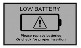
Además de la frecuencia de uso, la duración de la batería se ve afectada por el uso de la luz de fondo y el receptor GPS. Si no es necesaria, la función GPS debe desactivarse. La luz de fondo se puede fijar en modo AUTO (p. 12). Esto permite suficiente tiempo para ver la lectura sin someter la batería a un esfuerzo innecesario. La tabla a continuación proporciona una estimación aproximada del número de lecturas que se pueden tomar dados ciertos parámetros de configuración.
