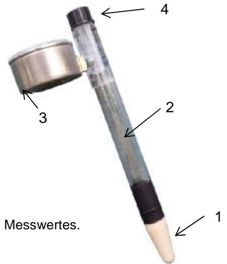
Das Manometer misst Unterdruck im Bereich -250 bis 0 hPa (= mbar).
