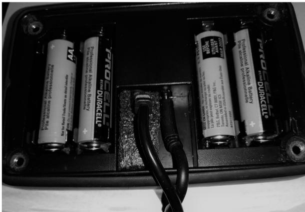
Fig. 1: Cable conectado. Retenedor de espuma
