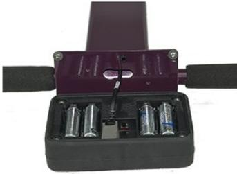
Abbildung 1. Verbindung des Sensorkabels mit der Platine.
