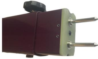
*Abbildung 1. Schaft, Sicherungsschraube und Messnadeln*
