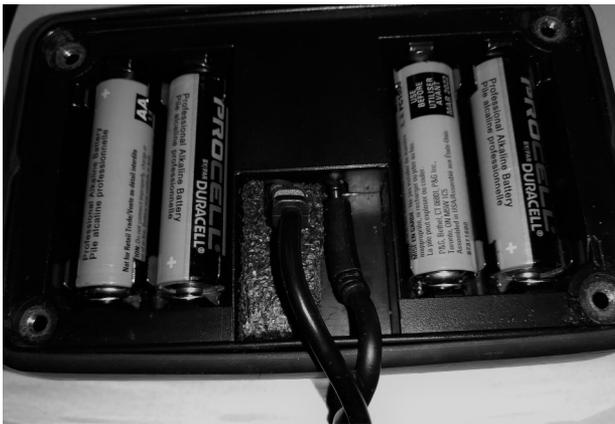
Abb. 1: Angeschlossenes Kabel. Eingelegtes Schaumstoffkissen.
